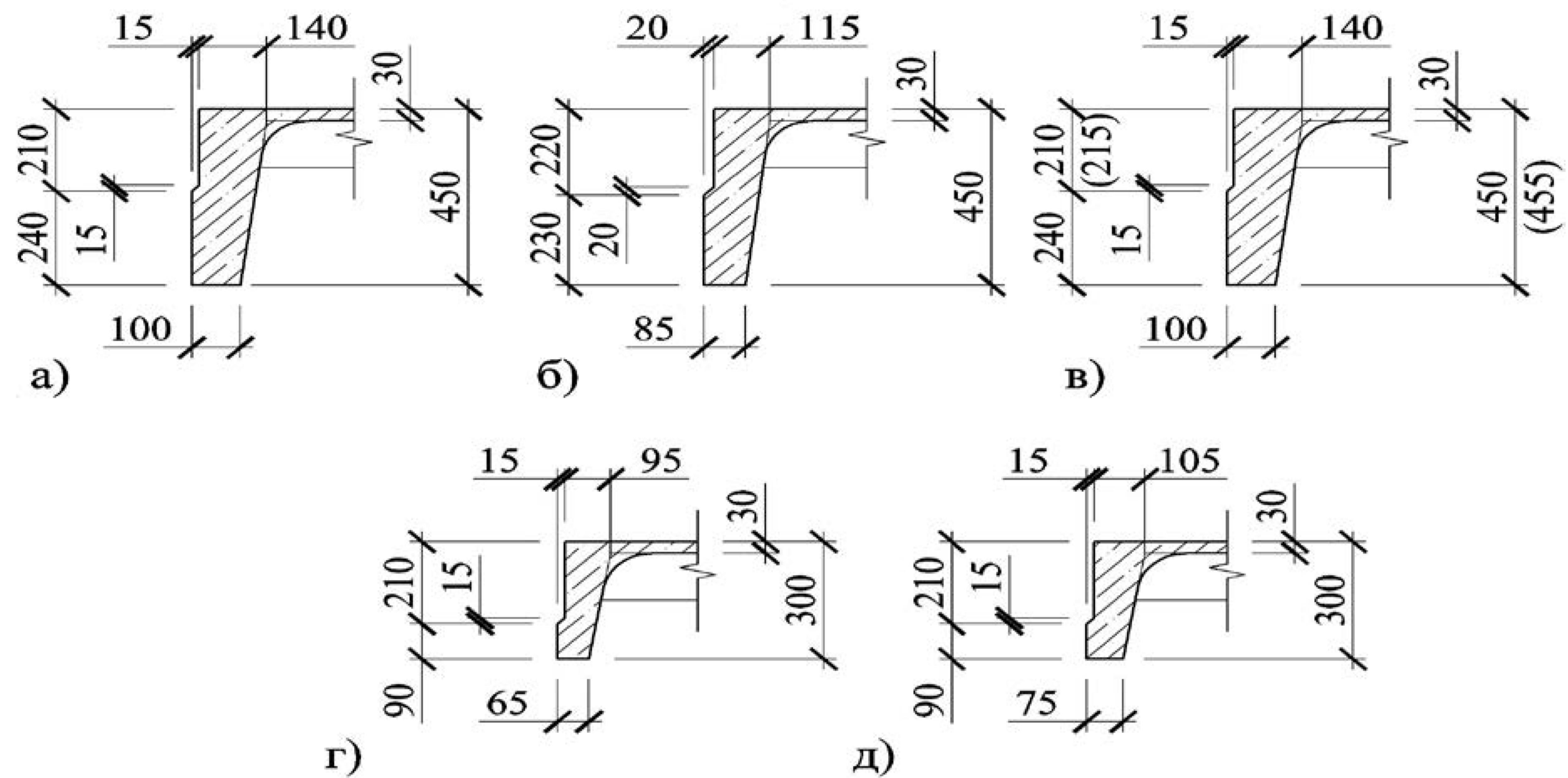
а – плиты 3ПГ12, 3ПВ12, 3ПЛ12; б – плиты 1ПГ12, 1ПВ12, 1ПФ12, 1ПЛ12;
