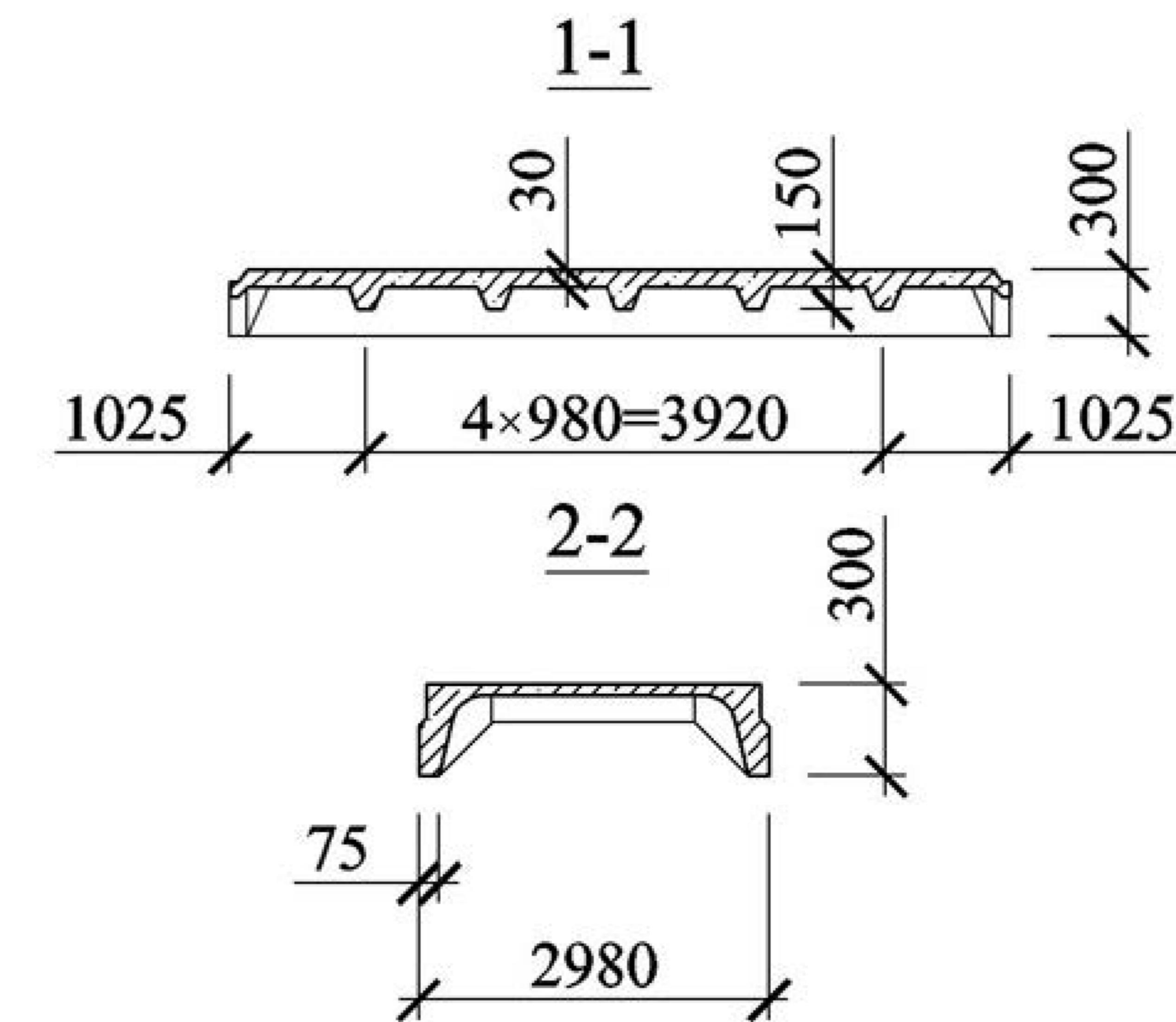
22 Плита типоразмера ЗПВ6 с проемами диаметром 400 или 700 мм
