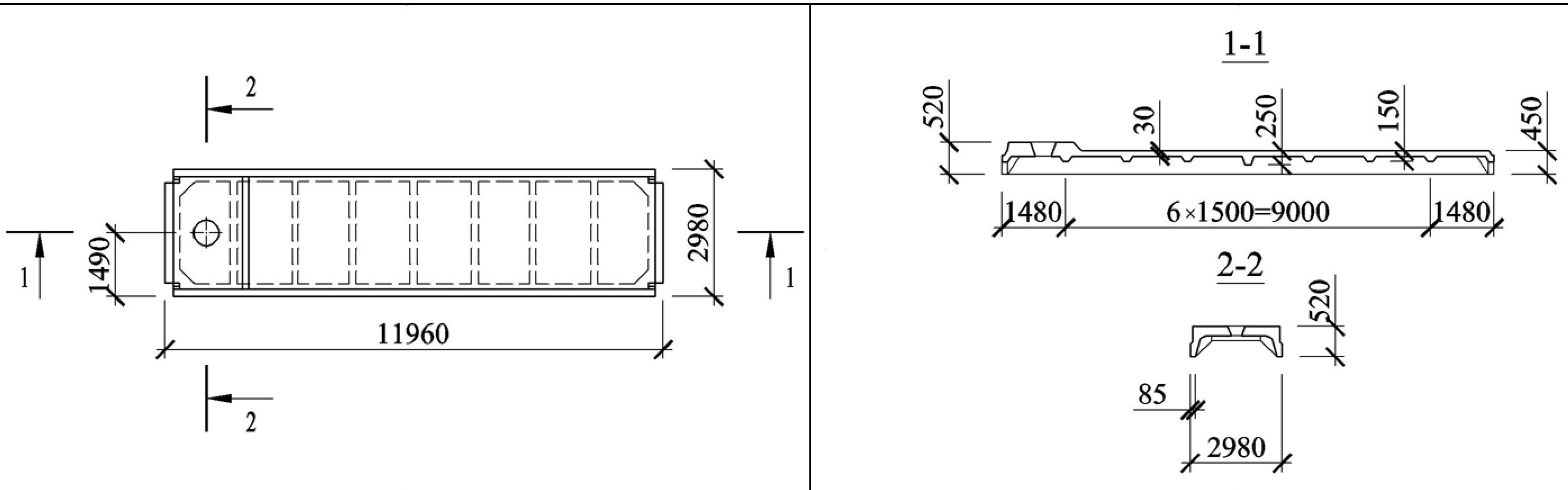
6 Плита типоразмера 1ПВ12 с проемом диаметром 1450 мм
