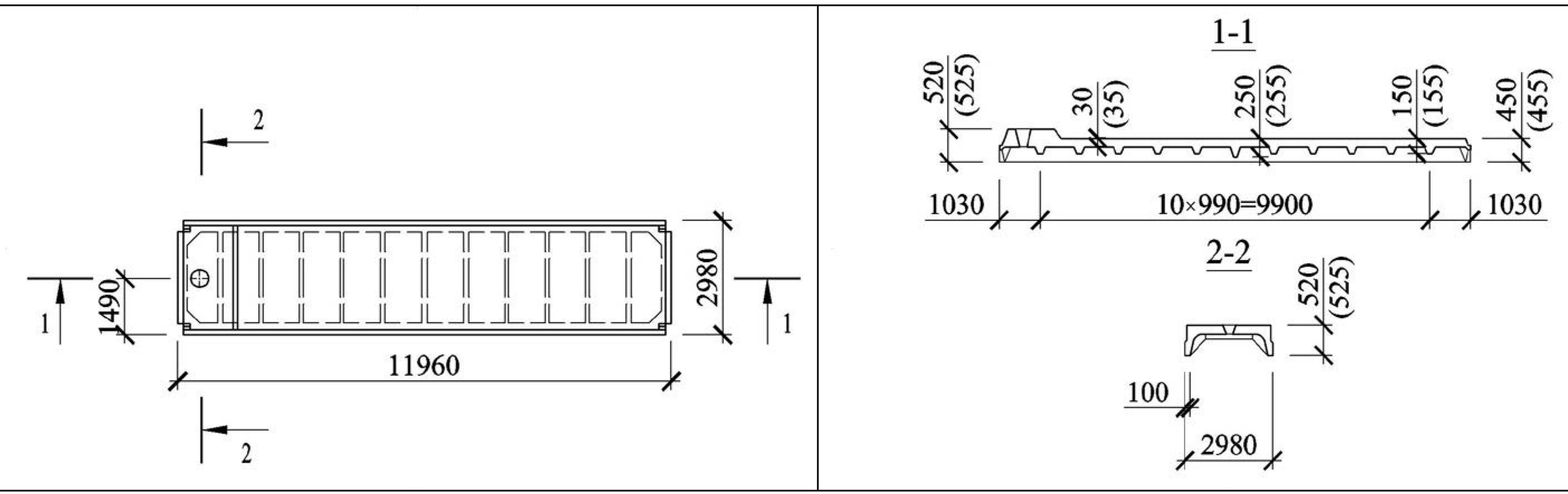
12 Плита типоразмера 2ПВ12 с проемом диаметром 1000 или 1450 мм
