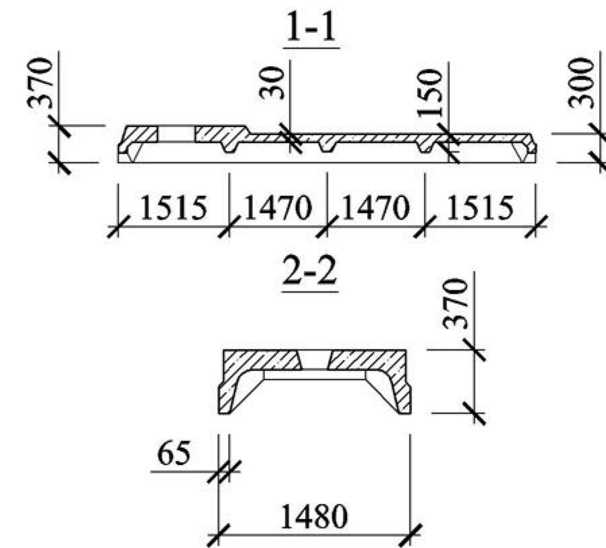
18 Плита типоразмера 4ПФ6 с одним проемом размерами 1200×1700 мм
