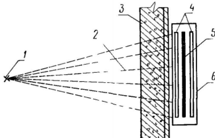
1—источник излучения; 2—поток ионизирующего излучения; 3—просвечиваемый участок конструкции; 4—усиливающие экраны; 5—пленка; 6—кассета
