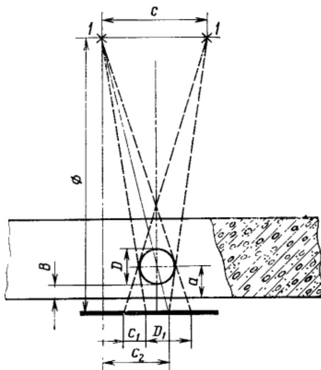
$D$ —диаметр арматурного стержня;  $D_1$ —проекция арматурного стержня;  $B$ —толщина защитного слоя;  $\Phi$ —фокусное расстояние;  $C$ —расстояние между первым и вторым положением источника;  $C_1$ —смещение проекций арматурного стержня на пленке;  $C_2$ —расстояние от оси проекции стержня до прямой, проходящей через источник перпендикулярно поверхности пленки;  $a$ —расстояние от поверхности конструкции до центра арматуры; 1—источник излучения
