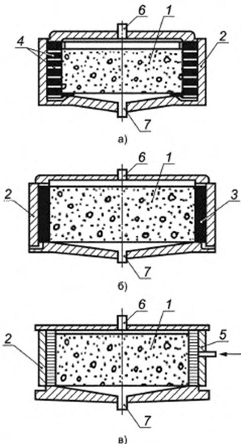
1 — образец бетона; 2 — испытательная обойма; 3 — мастика; 4 — набор резиновых и металлических колец; 5 — резиновая полая камера; 6 — съемная крышка для подачи воды; 7 — съемная крышка с патрубком для сбора фильтрата
