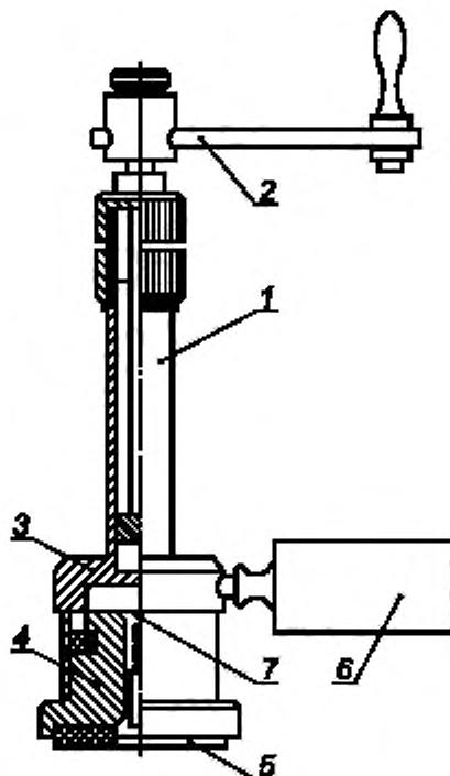
1 — гидравлический насос; 2 — ручка насоса; 3 — рабочий цилиндр; 4 — рабочий поршень; 5 — уплотнительная шайба;
