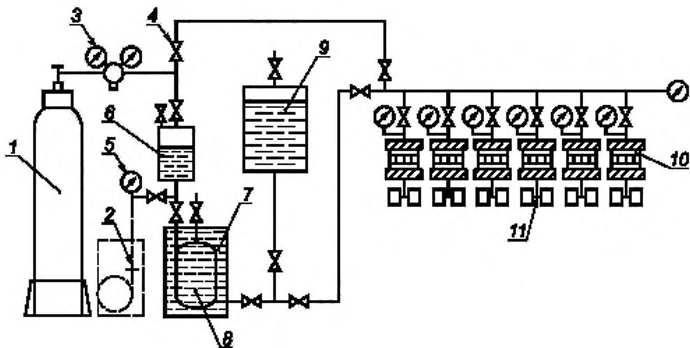
1 — баллон с газом; 2 — насос; 3 — редуктор; 4 — вентиль; 5 — манометр; 6 — передатчик давления; 7 — емкость с водой;
